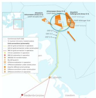
Allemagne. Il sera relié au point de raccordement au réseau dans le poste de Lubmin (Mecklembourg-Poméranie-Occidentale) via deux câbles sous-marins à haute tension, mesurant chacun 90 km de long, qui seront également installés par 50Hertz.
